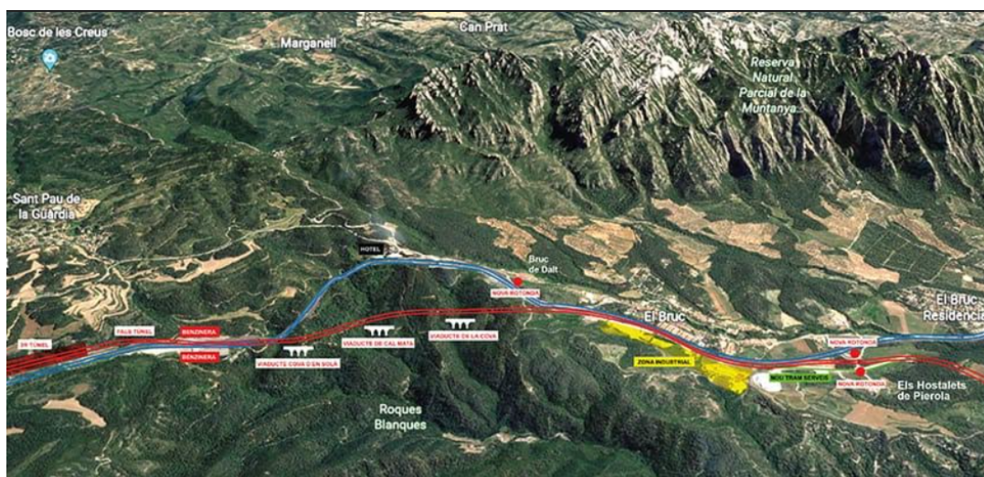
Mapa des de la sortida dels túnels del Bruc fins al terme d'Hostalets de Pierola i Collbató. En vermell el nou traçat de l'A2 passant per les Roques Blanques i dibuix dels viaductes.
